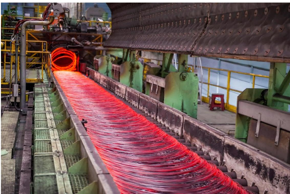
Поставленный Primetals Technologies конвейер Моргана Stelmor в работе
