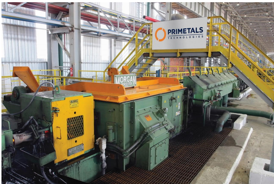
Laminador Morgan Vee Mini-Block em operação
