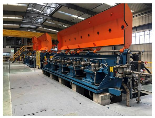
普锐特冶金技术制造的新型 SCR 9000 铜材轧机。它是南方线材有限责任公司迄今为止提供的最大能力轧机,已在江西铜业集团公司投入运行。
