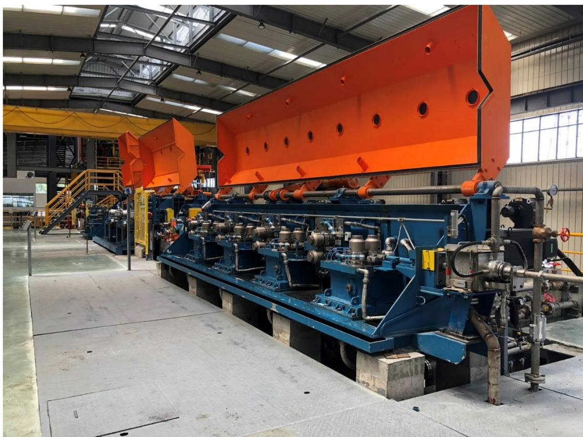
Die neue Kupferdrahtwalzstraße SCR 9000 von Primetals Technologies – die Anlage mit der höchsten Kapazität, die je an Southwire Company, LLC geliefert wurde – für den Einsatz bei der Jiangxi Copper Company.
