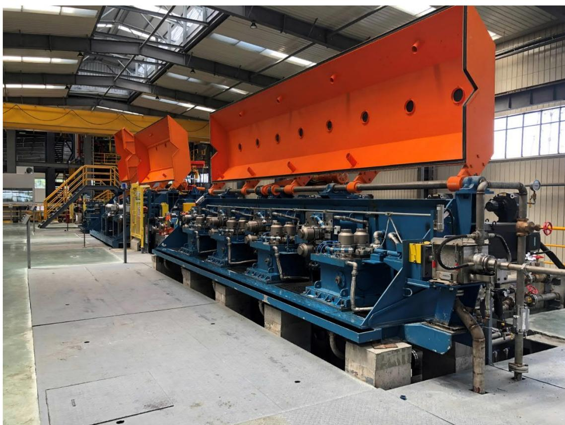
プライメタルズテクノロジー製の SCR 9000 用銅棒材圧延機。これまで江西銅業に納入した中で最高の生産能力を有します。
