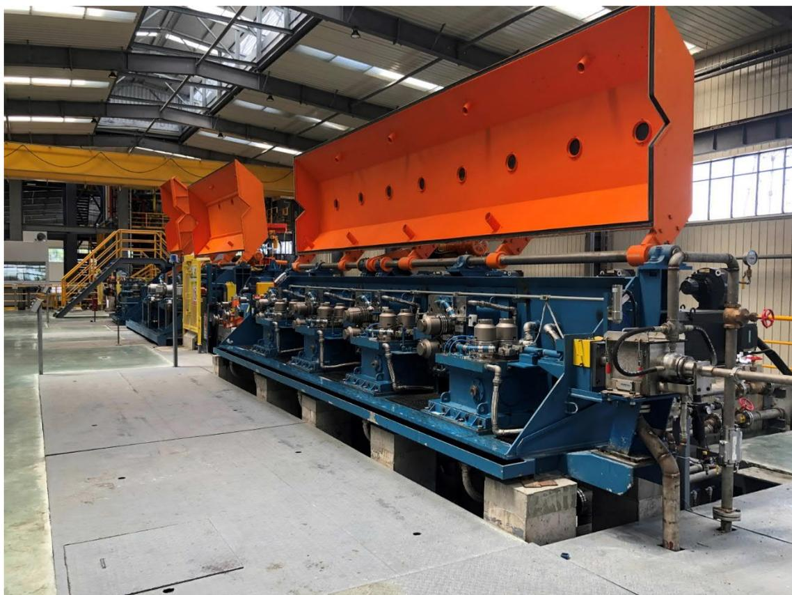
Novo laminador de barras de cobre SCR 9000 fabricado pela Primetals Technologies. Este é o laminador de maior capacidade fornecido para a Southwire Company LLC para operação pela Jiangxi Copper Company.
