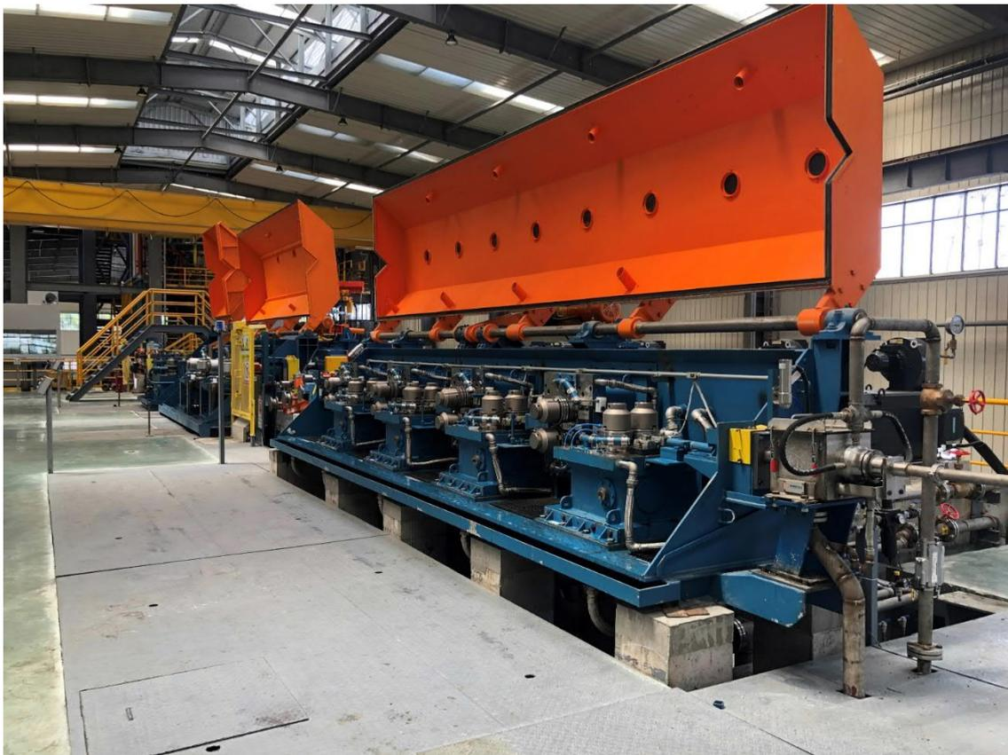
Новый стан SCR 9000 Primetals Technologies для производства медной катанки на производственной площадке Jiangxi Copper. Стан обладает самой высокой производительностью среди всех станов, когда-либо поставленных компании Southwire.
