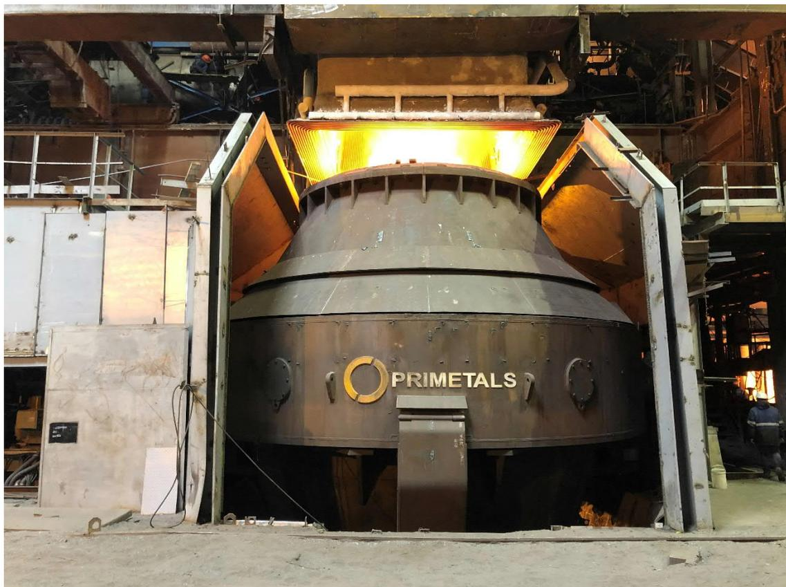
Von Primetals Technologies modernisierter LD-(BOF-)Konverter im Stahlwerk der Chelyabinsk Metallurgical Plant (ChMK), Teil der Mechel-Gruppe in Tscheljabinsk, Russland
