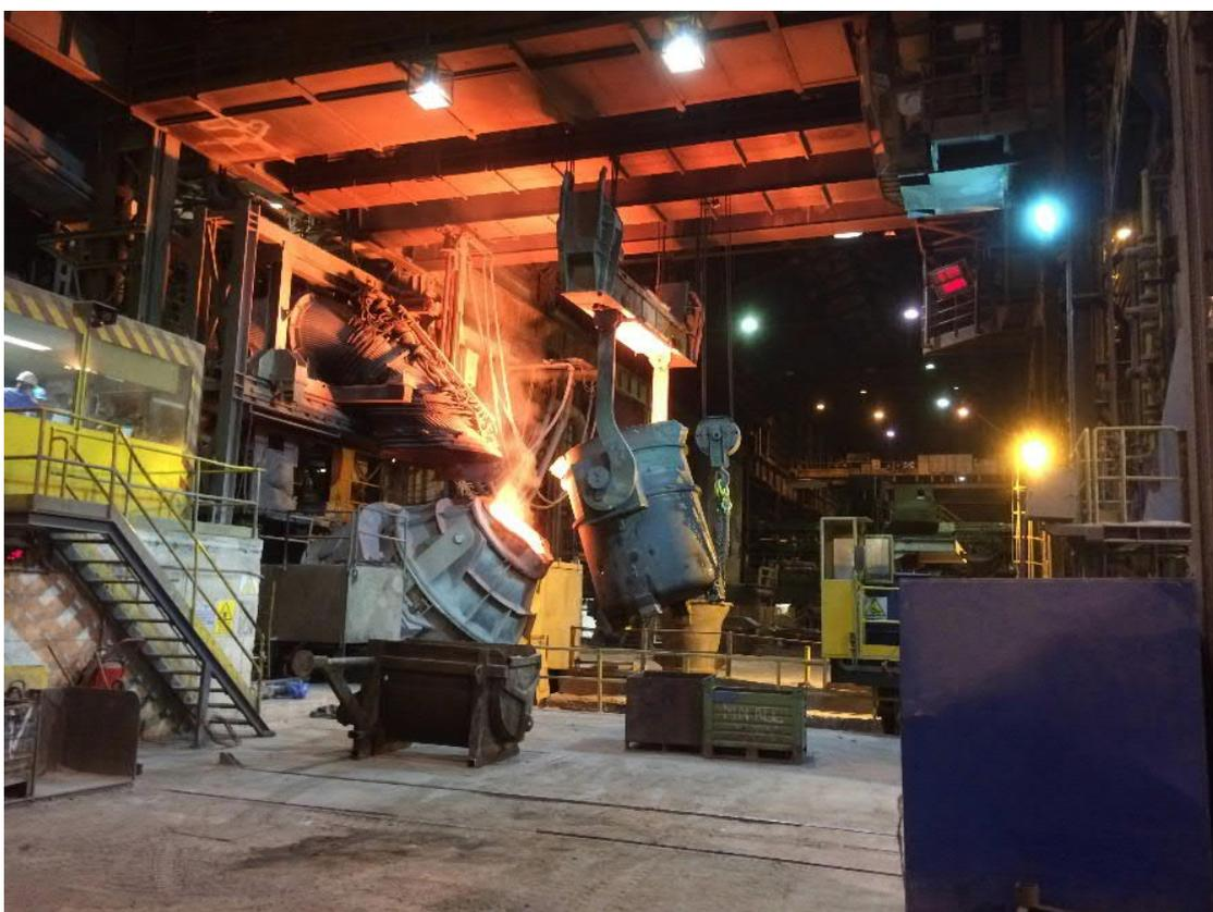
普锐特冶金技术为意大利 Valbruna 的一座 AOD 转炉改造了工艺优化和工艺控制系统以及托圈和倾动传动。
