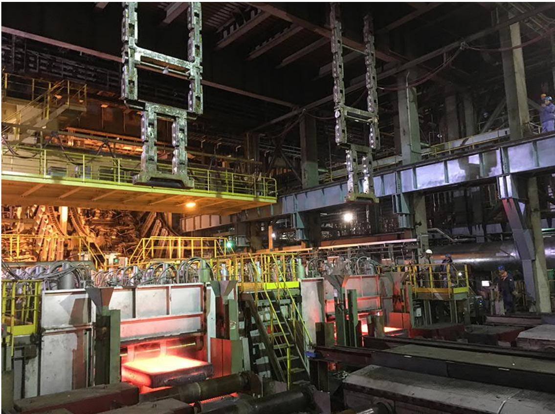
Mit dem neuen vollautomatischen Top-Feeding-Kaltstrangsystem von Primetals Technologies kann Baosteel nun vollständige Sequenzen, beispielsweise die Übergabe vom Hubwerk an den Wagen, mit nur einer Taste starten.
