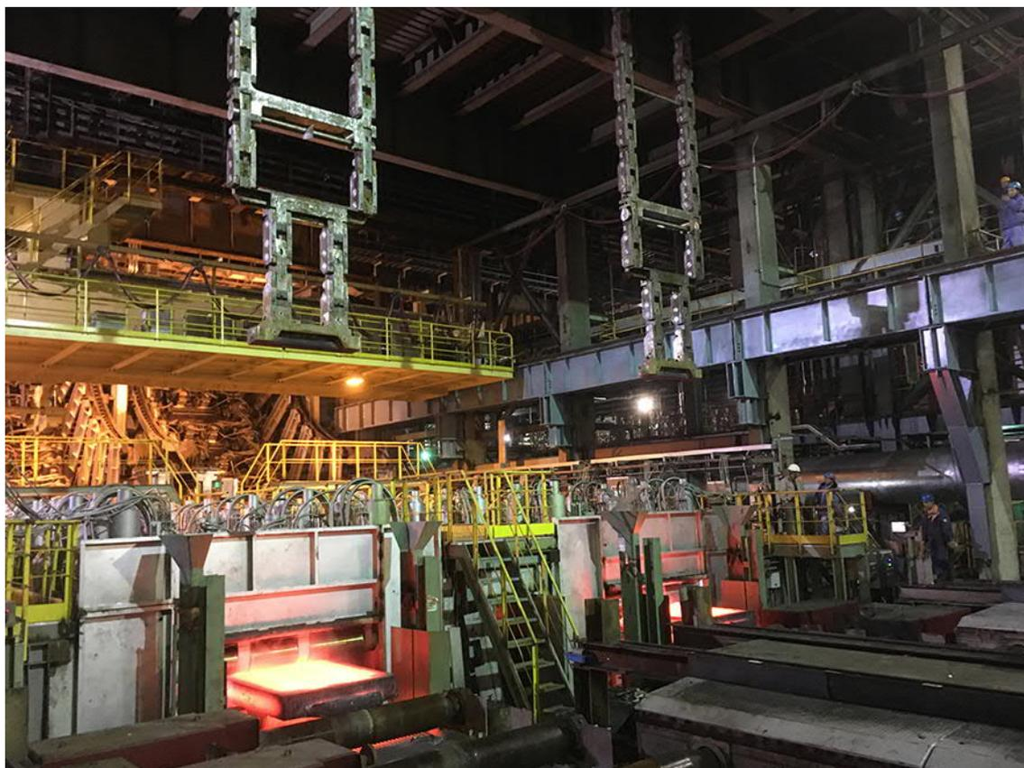
Com o novo sistema totalmente automático de alimentação da barra falsa pelo topo da Primetals Technologies, a Baosteel pode agora iniciar sequências completas, como a transferência do guincho para o carro de barra falsa, apenas acionando um botão.
