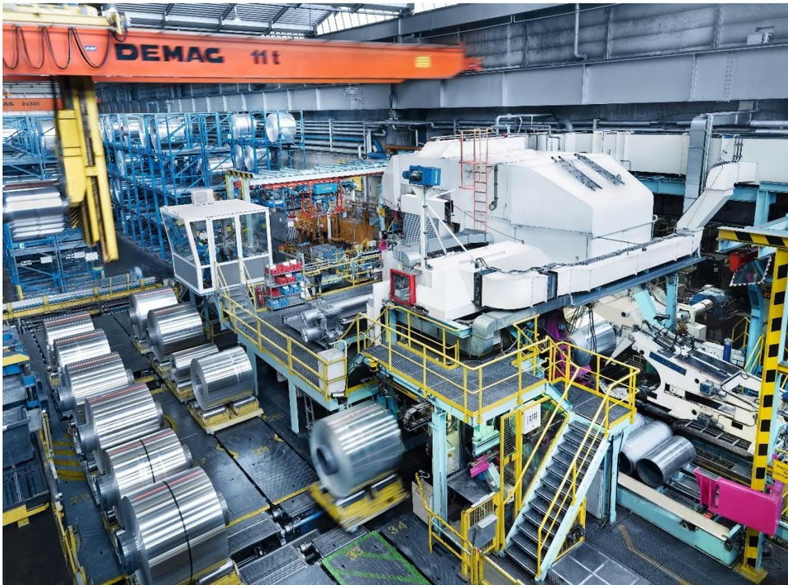
Cadeira do laminador quádruo a frio na usina da AMAG rolling GmbH em Ranshofen, Áustria. A planta está sendo modernizada pela Primetals Technologies. (Imagem por cortesia da AMAG rolling GmbH).
