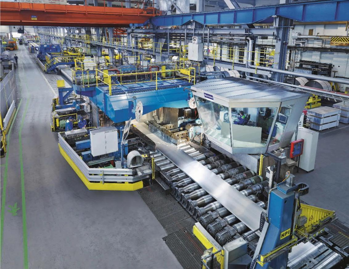
Warm-Duo-Walzgerüst der AMAG rolling GmbH in Ranshofen, Österreich. Die Anlage wird von Primetals Technologies mit neuer Umrichtertechnik ausgestattet. (Bildquelle: AMAG rolling GmbH)
