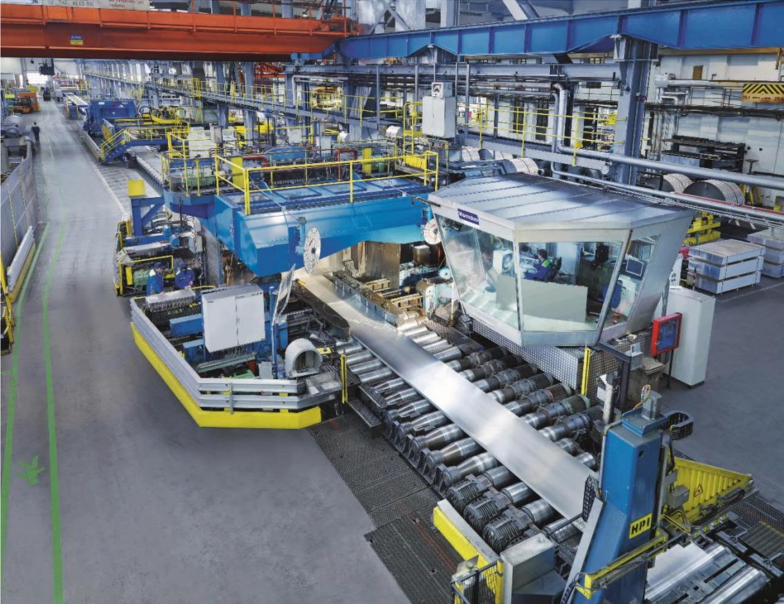
オーストリアの AMAG ローリング社ランスホーフェン工場にある 2 段式熱間圧延スタンド。プライメタルズテクノロジーズが、このラインに新型のコンバータを設置します。（写真提供：AMAG ローリング社）
