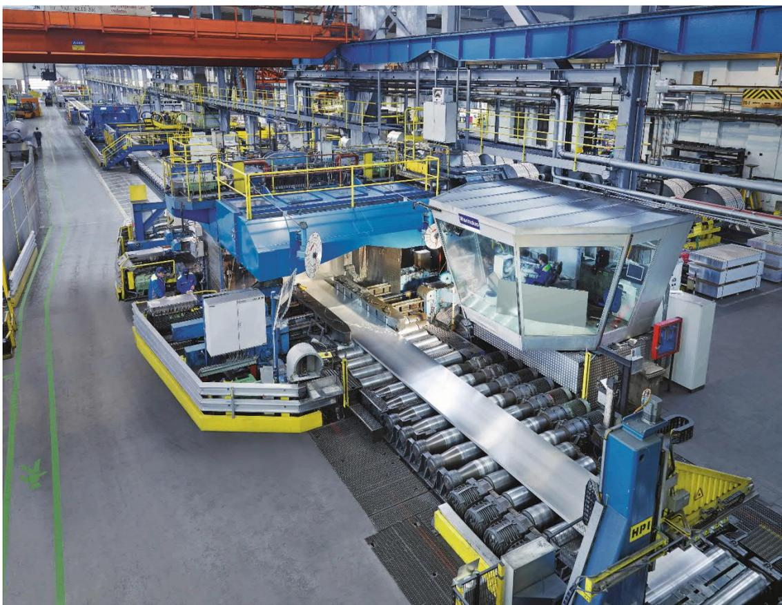
Laminador duo a quente na planta da AMAG rolling GmbH em Ranshofen, Áustria. A Primetals Technologies equipará a laminação com novo ciclo conversor. (Foto: AMAG rolling GmbH)
