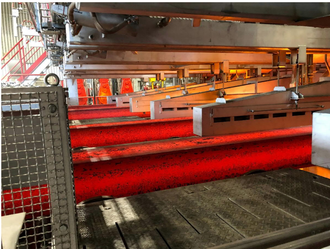
Первая разливка металла на блюмовой МНЛЗ на заводе voestalpine в г. Леобен
