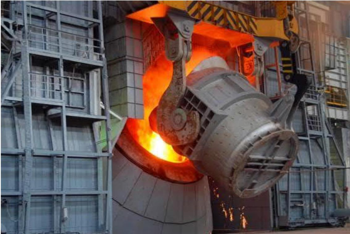
Primetals Technologies rüstet den bestehenden BOF-Konverter bei Handan Iron and Steel mitsamt dem kompletten Automatisierungssystem auf einen KOBM-Konverter auf.
