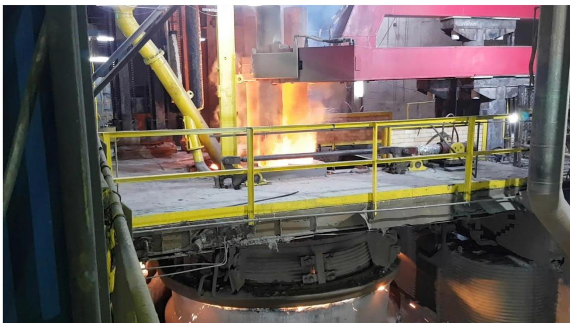
钢包炉正在处理第一炉
