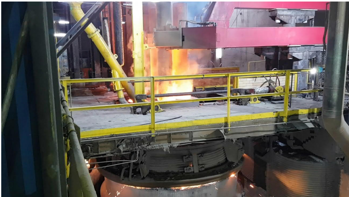
Установка печь-ковш во время первой обработки плавки
