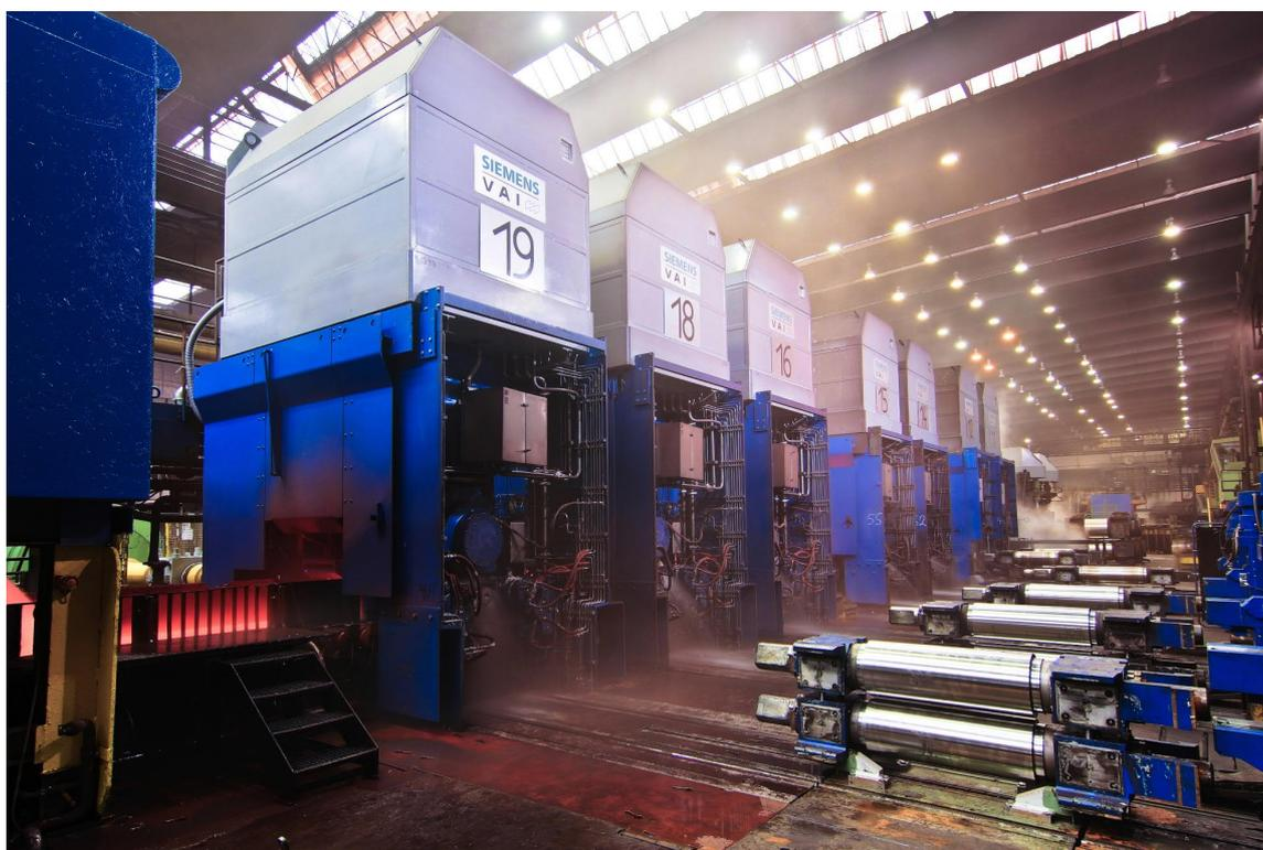
ドイツ、ホーエンリンブルグにあるティッセンクルップ ホーエンリンブルグ社のプラントの中形帯鋼圧延機。プライメタルズテクノロジーズは、新しい駆動システムを納入（画像提供：ティッセンクルップ ホーエンリンブルグ社）
