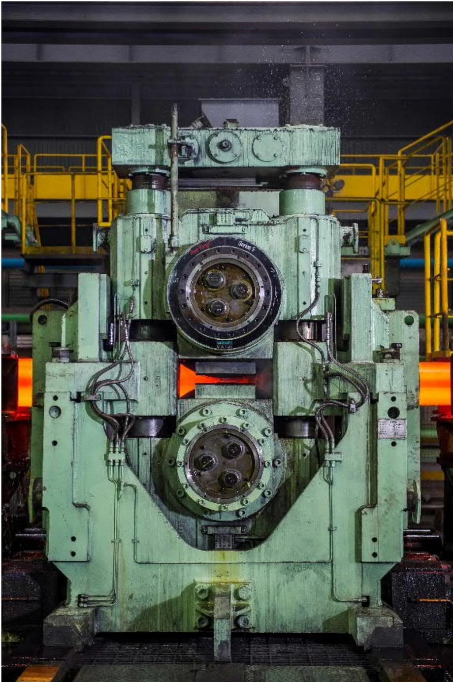
Gaiola de laminação Red Ring Series 5 da Primetals Technologies.
