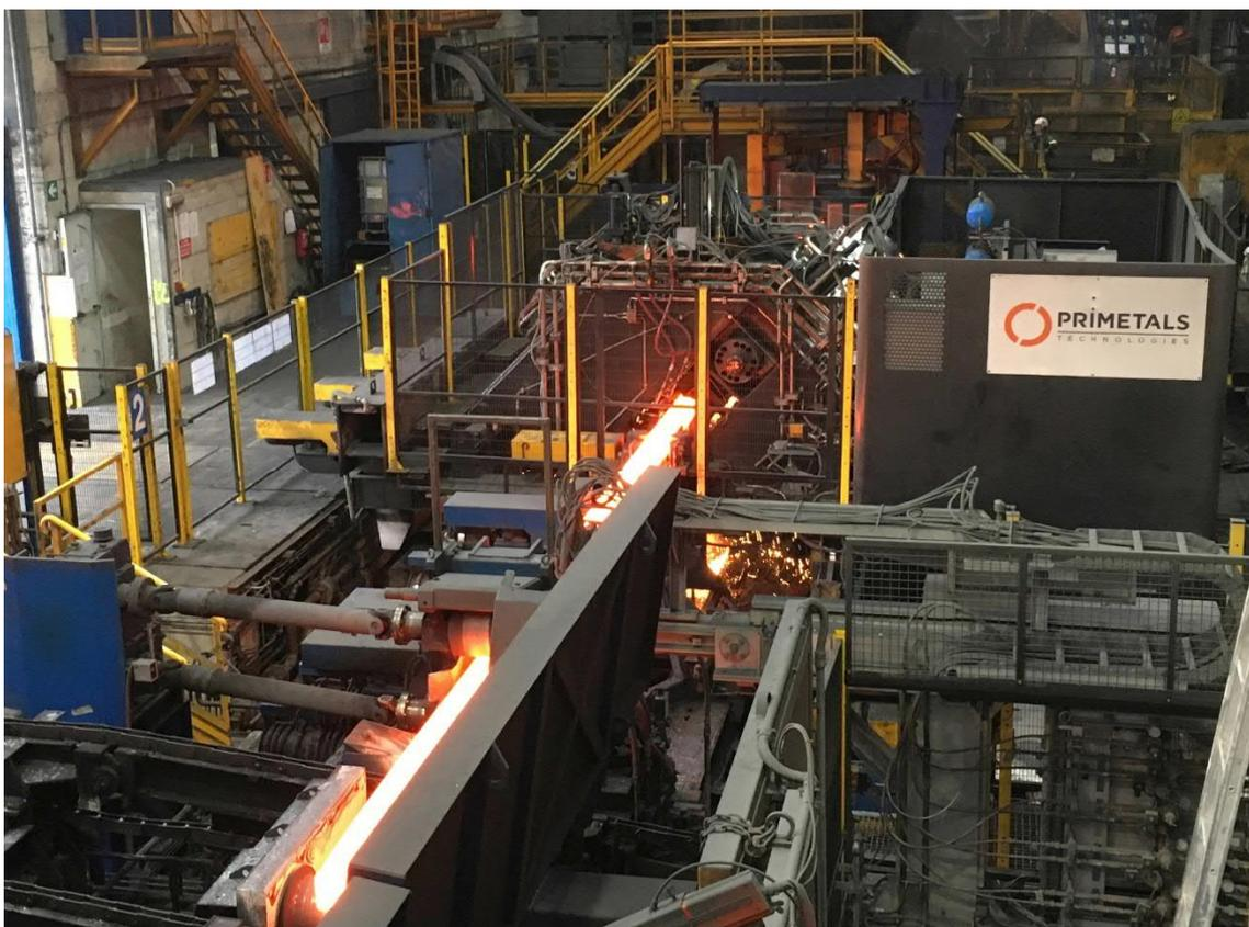
Il sistema di saldatura billette ERT-EBROS di Primetals Technologies installato presso Ferriera Valsabbia S.p.A. a Odolo.
