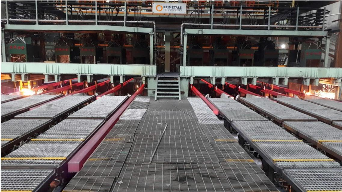
Zehnsträngige Knüppelgießanlage im Konverterstahlwerk Nr. 3 am Standort Changzhou des chinesischen Stahlerzeugers Zenith Steel. Die Gießanlage wurde von Primetals Technologies geliefert und ist mit SRD-Segmenten für Hard Reduction sowie speziellen Technologiepaketen ausgerüstet.
