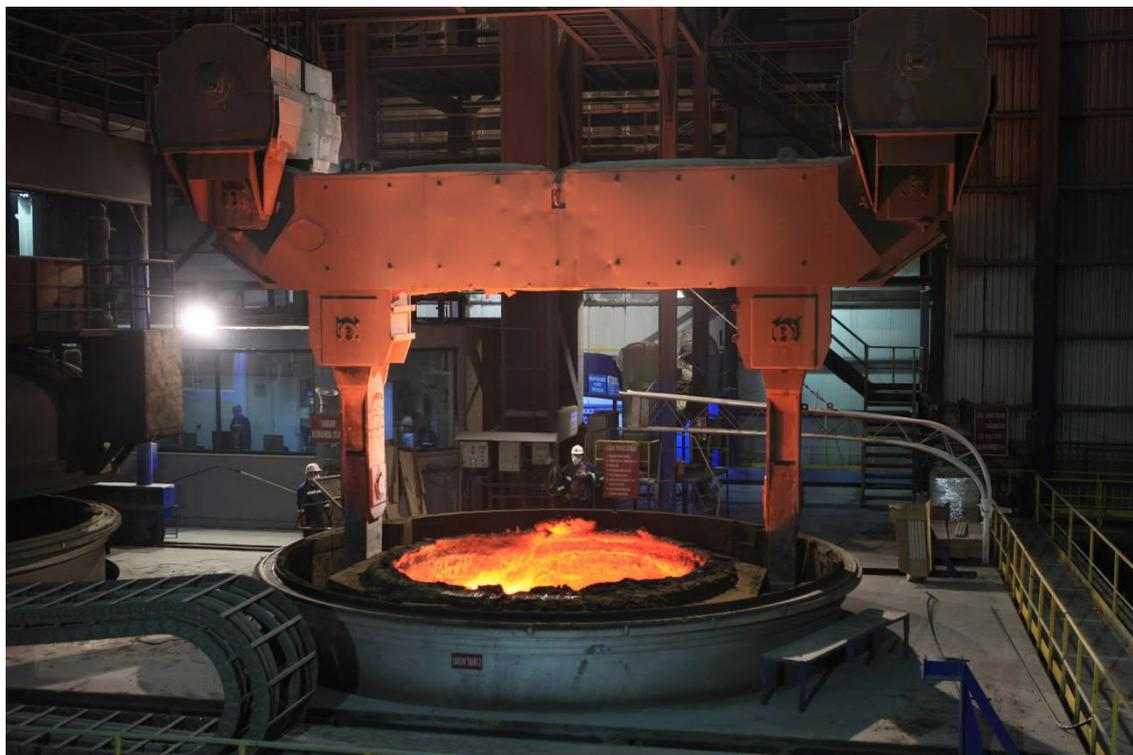
Im Stahlwerk Dilovası des türkischen Stahlerzeugers Çolakoğlu Metalurji A.S. (Çolakoğlu) modernisierte Primetals Technologies eine bestehende VD-Anlage (Vakuumentgasung), um sie zu einer VOD-Anlage (Vakuum-Sauerstoff-Entkohlung) aufzurüsten.
