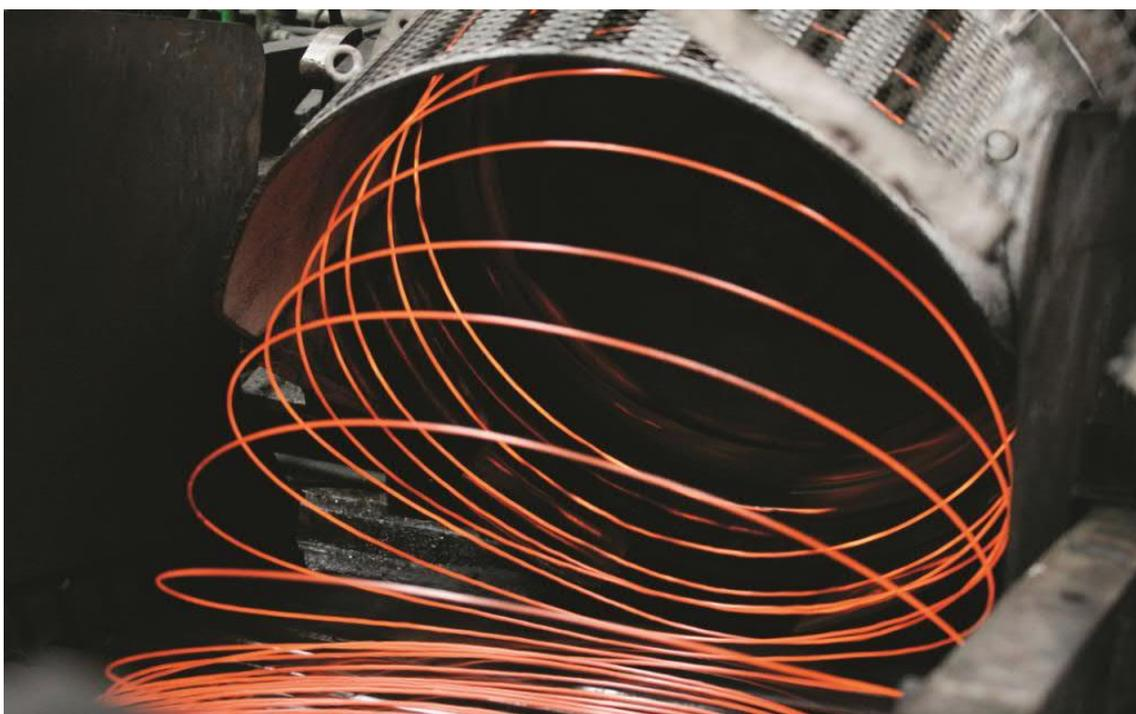
Высокоскоростной виткообразователь Morgan компании Primetals Technologies
