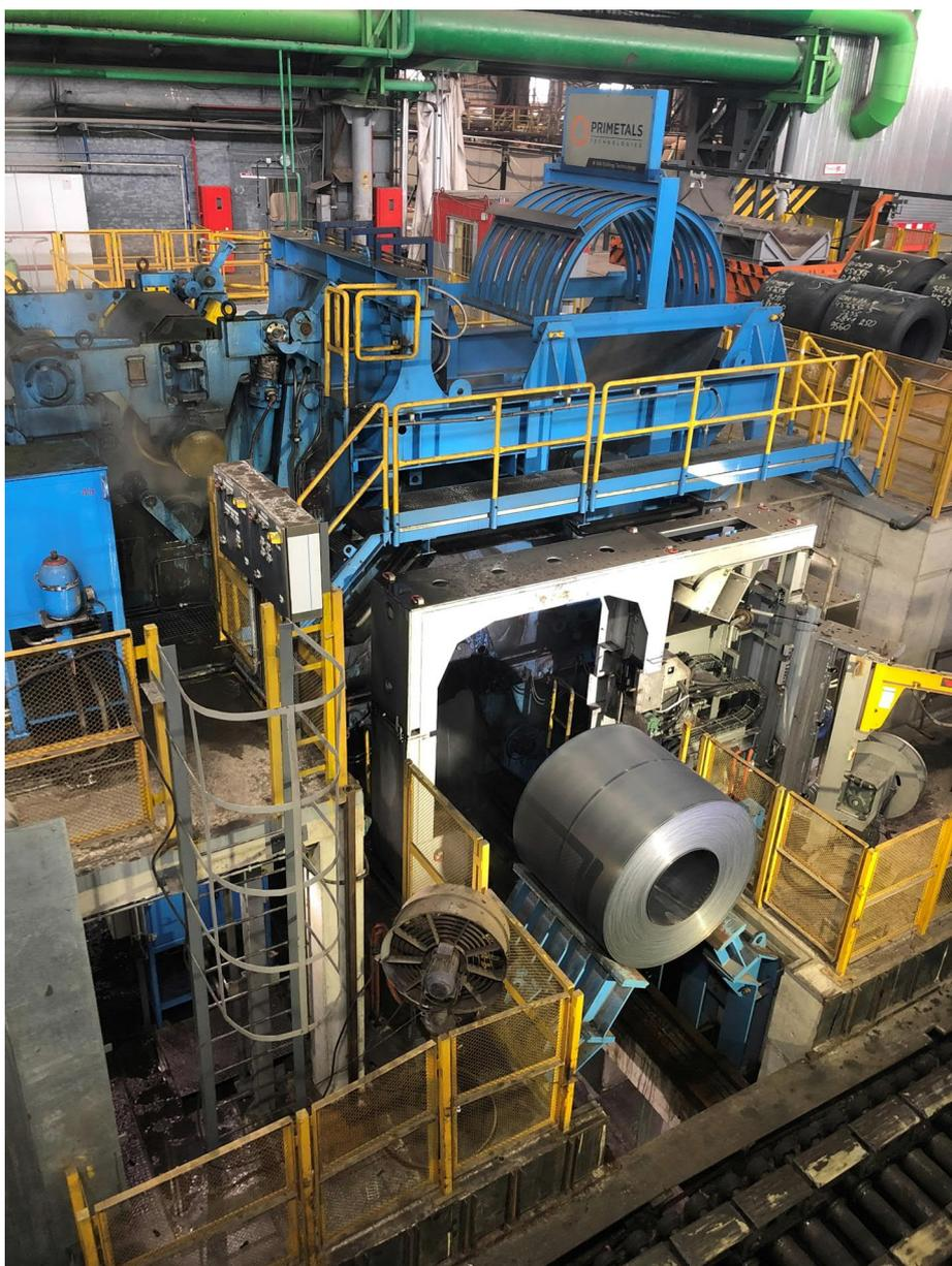
マリウポリ・イリッチ製鉄所熱間圧延設備 1700 に新設されたダウンコイラー
