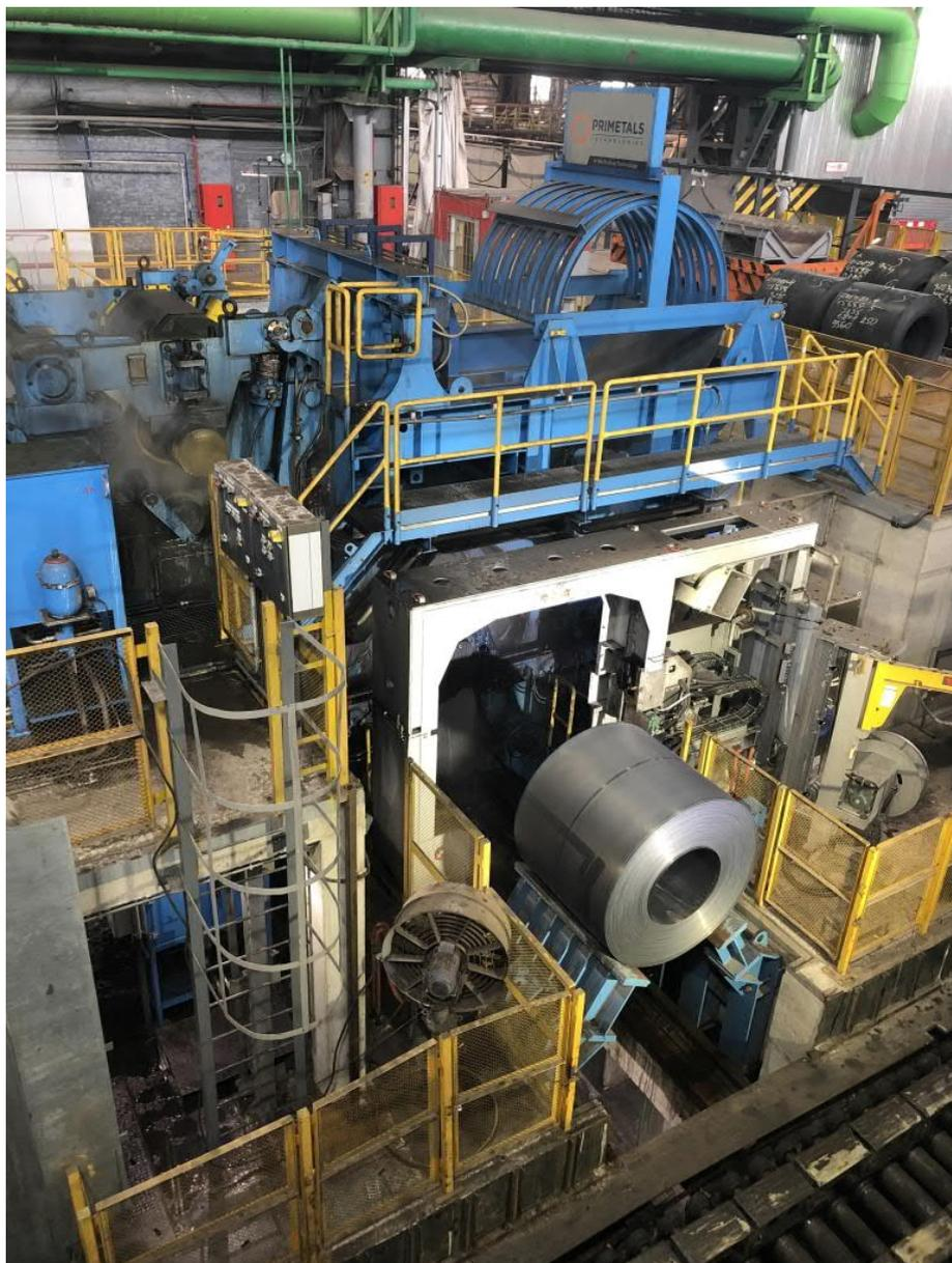
Nova bobinadeira no Laminador de Tiras a Quente de 1700 mm na Ilyich Iron and Steel Works of Mariupol, instalado pela Primetals Technologies.
