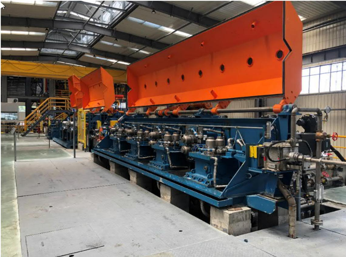
プライメタルズテクノロジーズがサウスワイヤ社向けに製作する SCR 9000S 銅棒圧延機の標準配置
