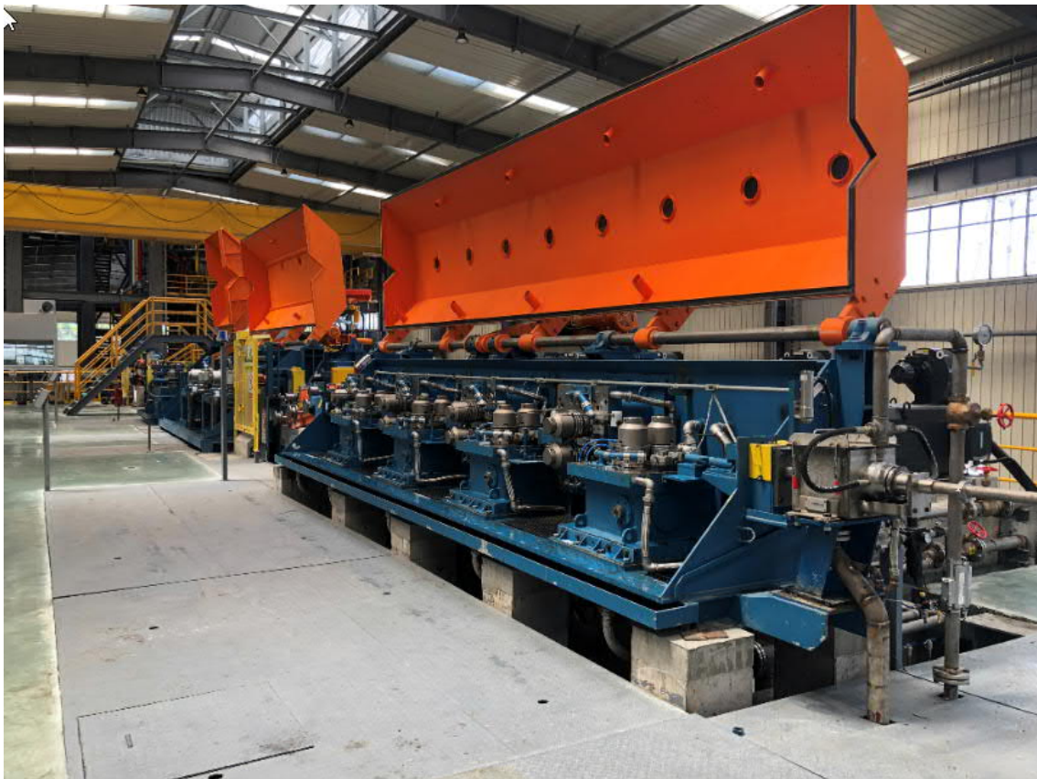
Стандартная компоновка стана для производства медной катанки SCR 9000S от Primetals Technologies для Southwire Company, LLC
