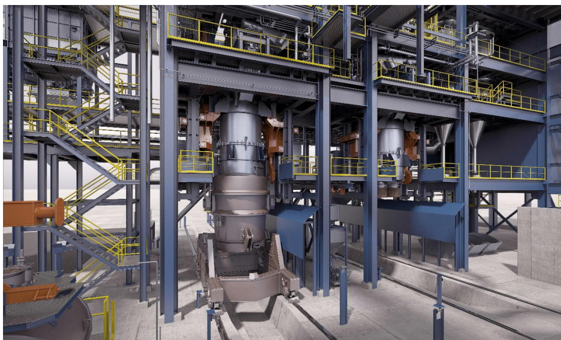
プライメタルズテクノロジー製のツイン Rh 式脱ガス設備と昇降装置 CVL
