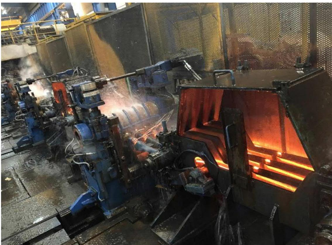
Laminazione divisa (slitting) 4x nel nuovo laminatoio di Amreli Steels Ltd., Pakistan, fornito da Primetals Technologies.
