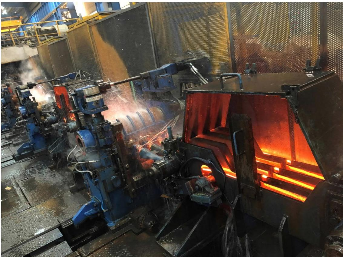
Operação Slitting de laminação em quatro veios no novo laminador de barras da Amreli Steels Ltd., Paquistão, fornecido pela Primetals Technologies.
