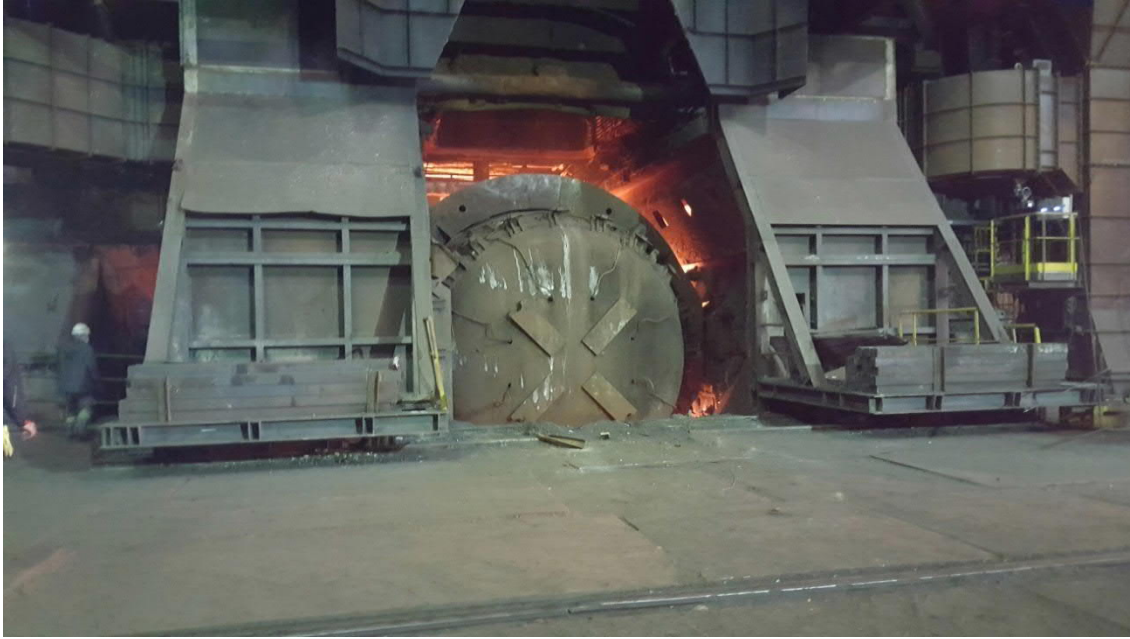
阿赛洛米塔尔 Zenica 目前的 2 号转炉
