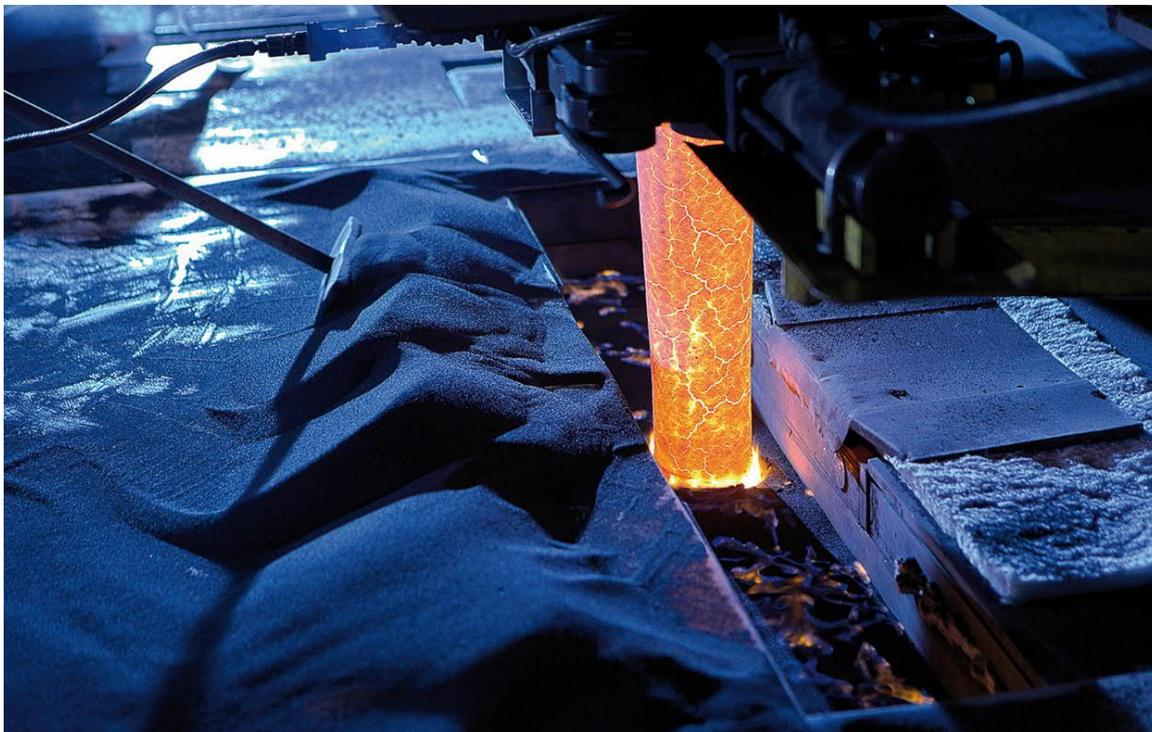
Primetals Technologies' Mold Expert verhindert Durchbrüche bei Stranggießanlagen und reduziert den Wartungsaufwand.
