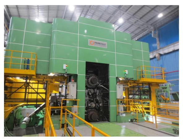
Первый стан Hyper UC производства Primetals Technologies для производства легких строительных материалов во Вьетнаме
