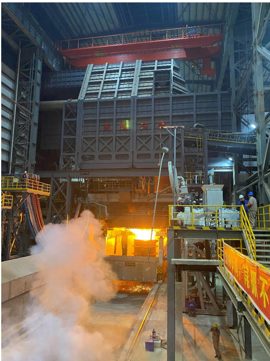
Forno elétrico a arco EAF Quantum com doghouse para atender aos mais altos padrões ambientais na Guilin Pinggang, China
