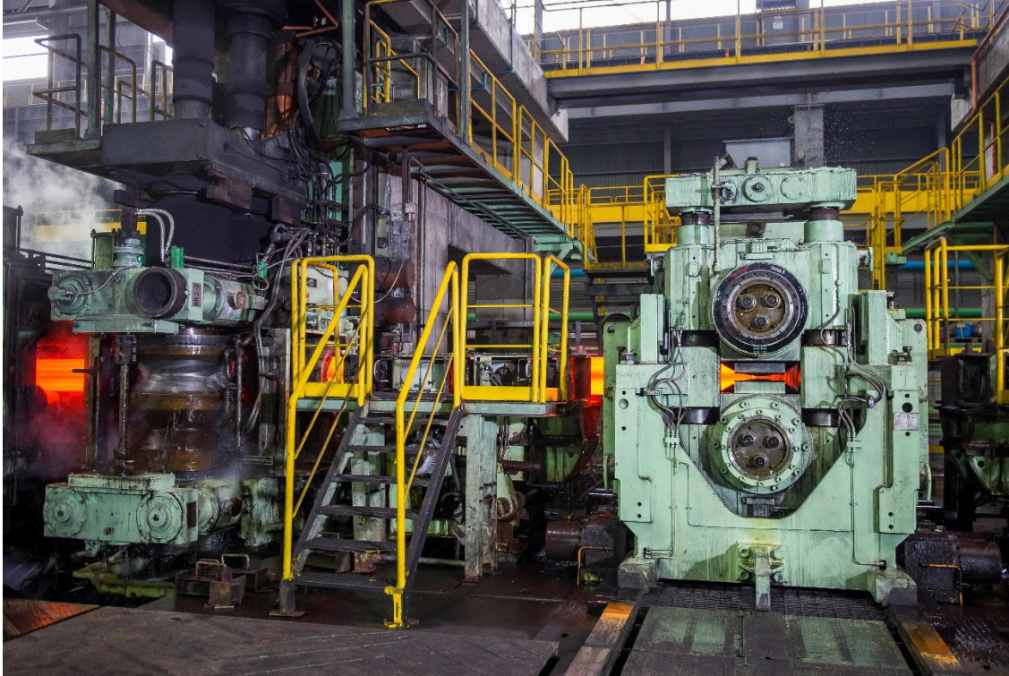
Trem de laminação com gaiolas Red Ring Series 5 da Primetals Technologies
