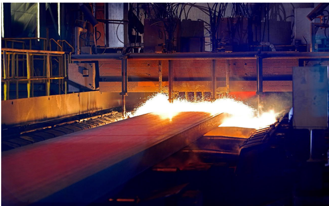
Brennschneiden an einer Edelstahl-Stranggießanlage von Primetals Technologies
