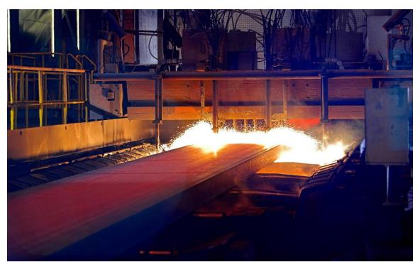
Operação de corte a maçarico em uma máquina de lingotamento contínuo de aço inoxidável da Primetals Technologies
