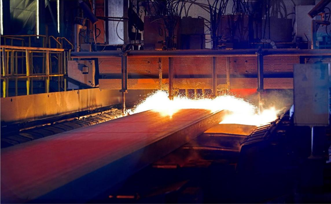
Газовая резка на производящей нержавеющей сталь МНЛЗ поставки Primetals Technologies
