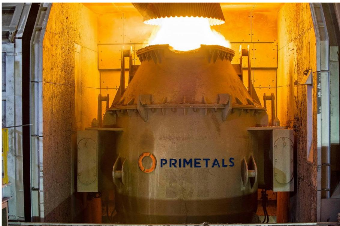
Novo convertedor AOD (descarbonetação por oxigênio e argônio) fornecido pela Primetals Technologies para a siderúrgica alemã BGH Edelstahlwerke GmbH em Freital, Saxônia, Alemanha.
