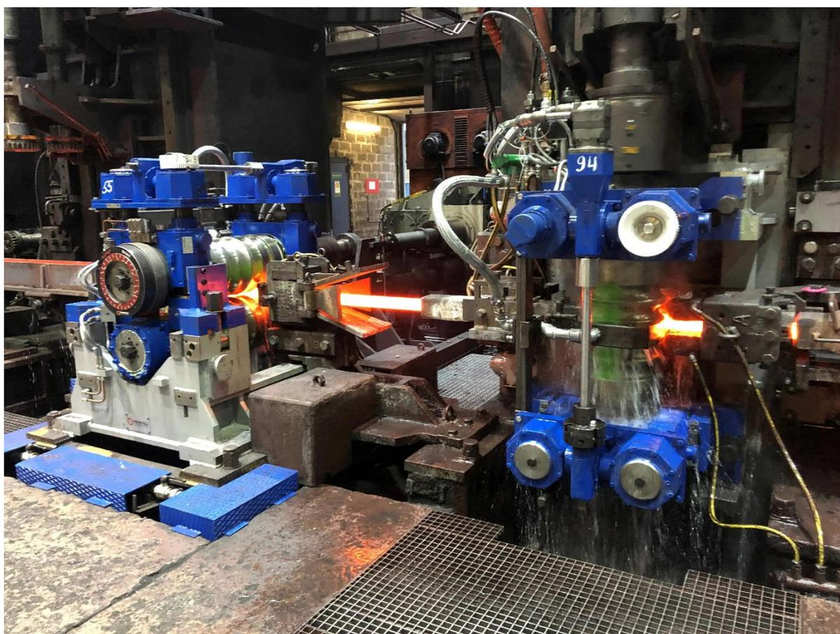
Gabbie di laminazione Red Ring Serie 5 senza spalla di Primetals Technologies. Sedici di queste gabbie saranno installate nel laminatoio per barre per armature fornito a Pak Steel.
