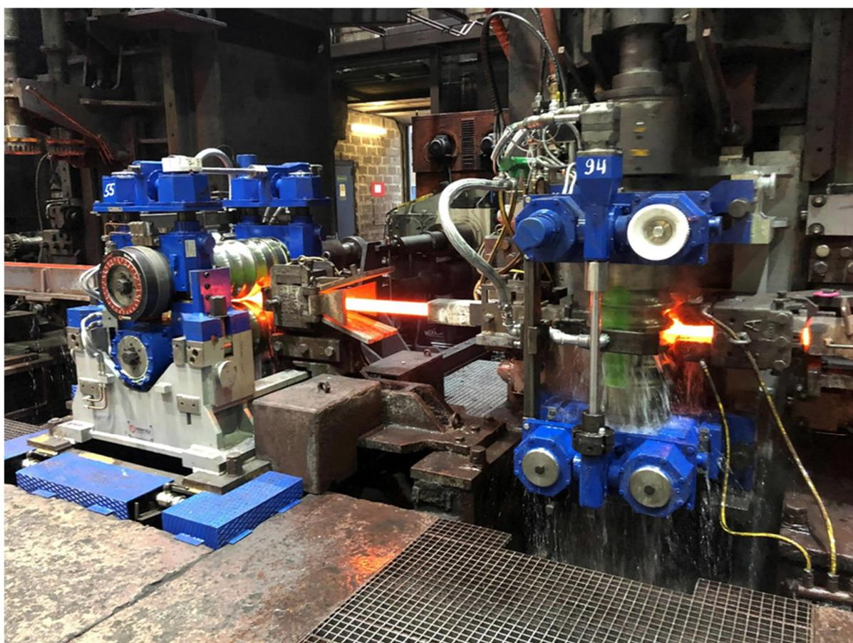
16 台のプライメタルズテクノロジーズ製ハウジングレス Red Ring シリーズ 5 がパクスティール社の新設棒鋼圧延機に導入予定
