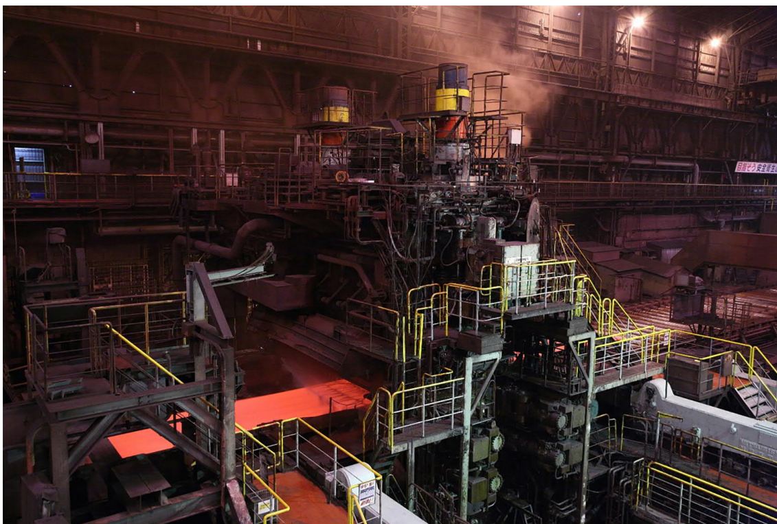
Стан чистовой прокатки повышенной жесткости Primetals Technologies для завода Kobe Steel в г. Какогава
