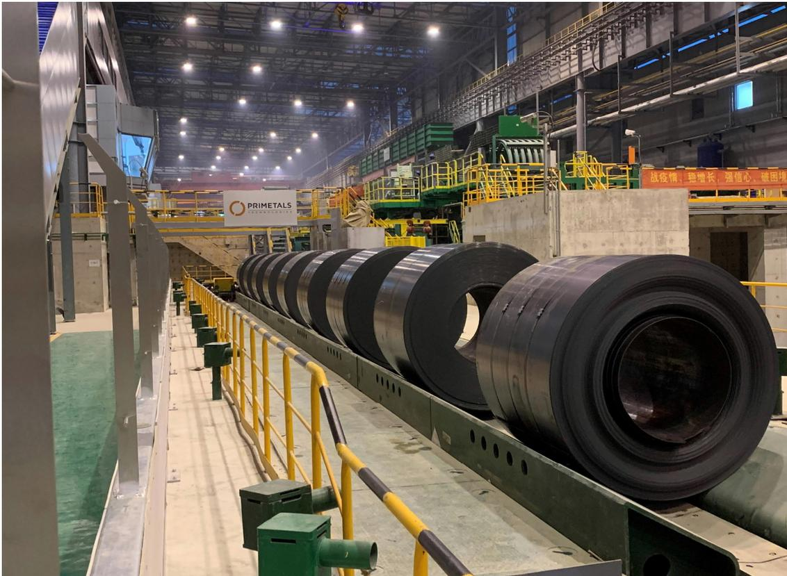
プライメタルズテクノロジーズのミニミルによる直接熱間圧延で、一度の加熱で生産されたコイル
