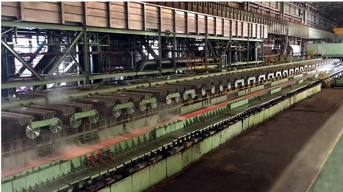
普锐特冶金技术为宝钢安装的新带钢层流冷却系统
