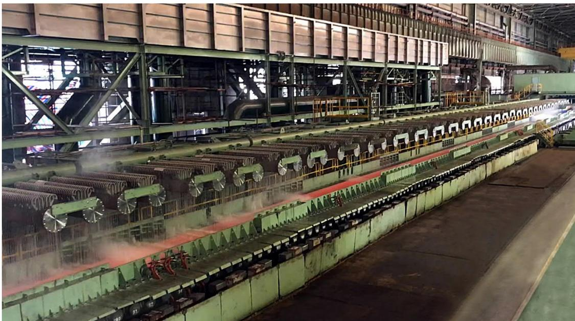
Neue laminare Bandkühlung von Primetals Technologies bei Baosteel eingeführt
