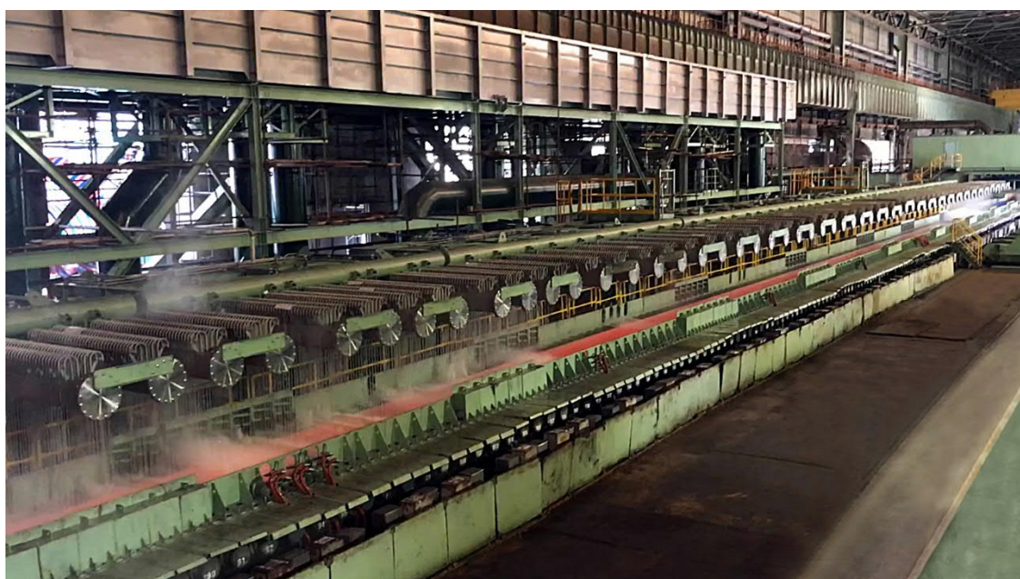
プライメタルズテクノロジーの宝山鋼鉄向けラミナー冷却設備
