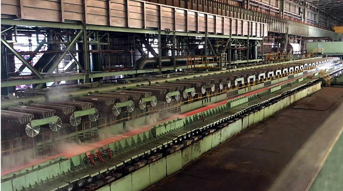
Новая система ламинарного охлаждения полосы, поставленная Baosteel компанией Primetals Technologies
