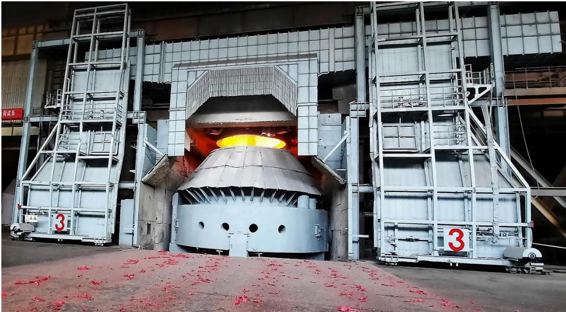
Inbetriebnahme des KOBM-Konverters Anfang November, der bei der HBIS Group Handan Iron and Steel in Handan, China, von Primetals Technologies von einem bestehenden BOF-Konverter umgerüstet wurde.
